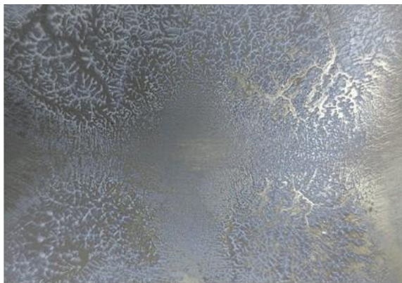
图9：导热硅脂分布示例及钢网示例
