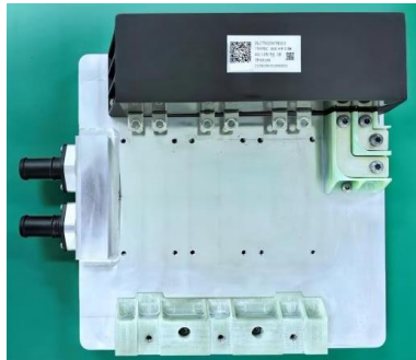
图7：ED3模块常用散热器
