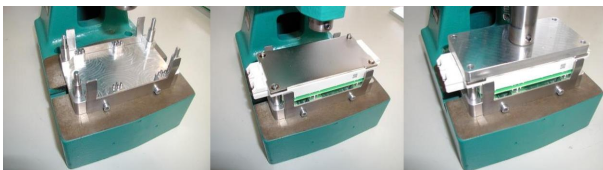
图8：压接流程步骤
